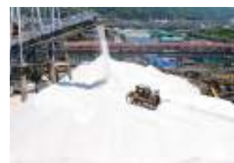
貯塩場にて、ブルドーザーを使用しての供給作業
