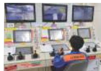
計器室にて、荷役重機を遠隔操作
